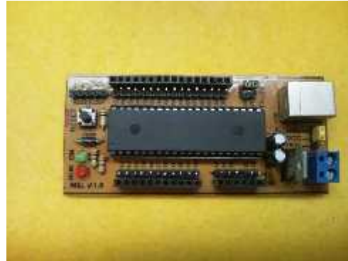
Figura I-2. Tarjeta de adquisición de datos multiplataforma por conexión USB, utilizada en el proyecto realizado en la universidad del Quindío, Colombia.
