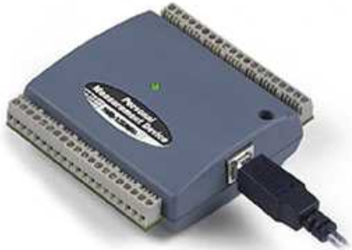
Figura I-1. Tarjeta de adquisición de datos USB -1208fs comercial, utilizada en el proyecto realizado en la Universidad Superior José Antonio Echavarría, Cuba.
