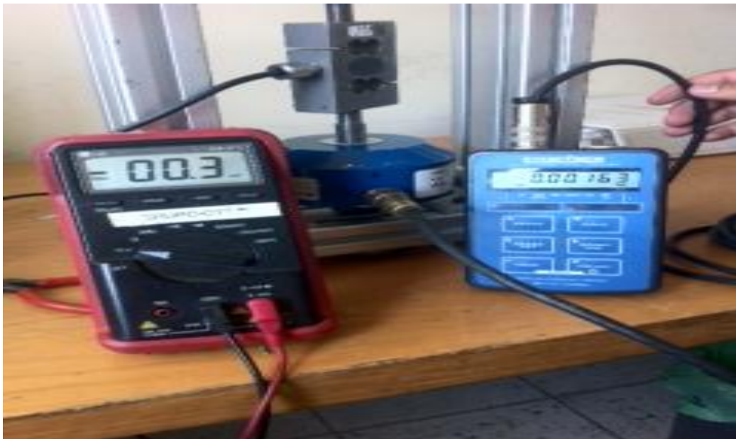
Figura 28. Resultados arrojados por la celda de carga de 5000N En esta imagen le introducimos fuerza a la celda de carga y una excitación de +10v y -10v y nos arroja los siguientes resultados se puede observar en el transductor y el multímetro normalmente cuando una celda está en buen estado nos arroja la sensibilidad de 2.3mv por cada volt que se aplica a la celda de carga.
