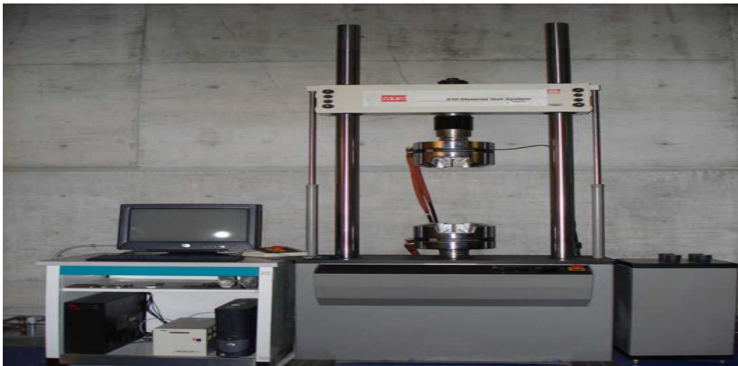
Figura 11. Marco de carga Hidráulica
