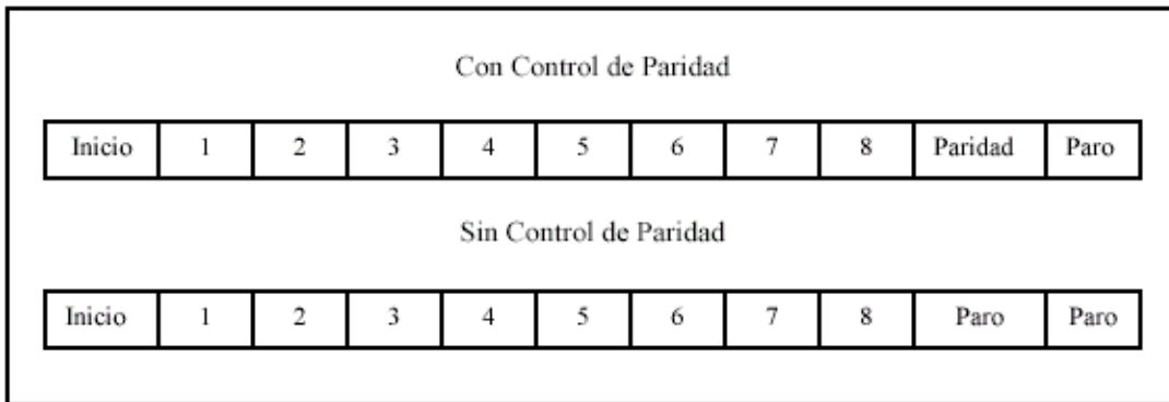
Figura 2.6 Orden de bits RTU
