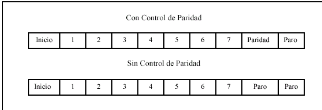
Figura 2.5 Orden de bits ASCII
