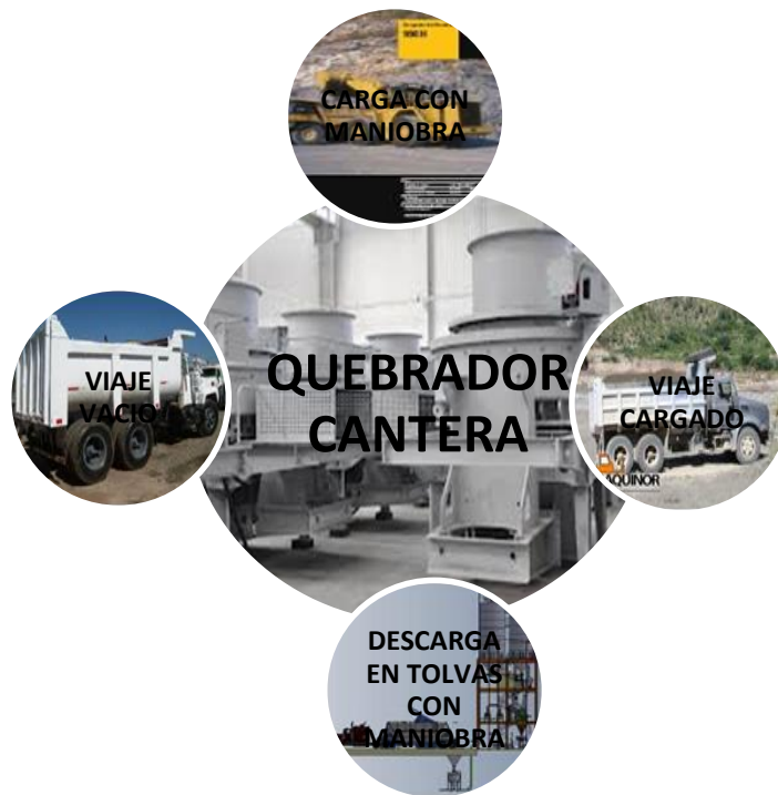
Fig. 5 Representación gráfica del proceso del acarreo de material a la quebradora cantera
